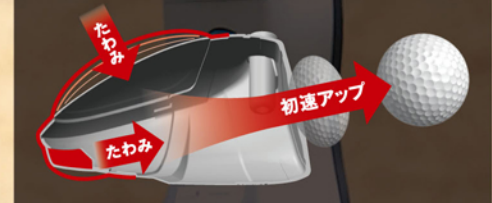
ヘッドの約45%にカーボン素材を採用し、バックフェース部に約25gのウェイトを装着。これにより重心が深くなり、広いスイートエリアを実現。また、フェースだけでなくヘッド全体のたわみ効果も増幅し、エネルギーがあまりなくボールに伝わる。
